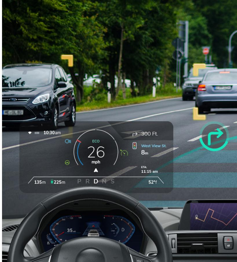
ADAS 기능은 고도로 개발되어 왔으며, 법률 규정 (EU위원회, US DoT, NHTSA 또는 기타 국가 기관)으로 인해 매년 표준 장비로서 모든 자동차 부문에 적용되고 있습니다. ADAS 알림은 현재 시각적 경고 및 청각적 사운드의 형태로 계기판을 통해 운전자에게 전달됩니다. 향후 사용 사례의 특성상 AR HUD가 장애를 회피, 전방 충돌 경고, 보행자 인식 및 기타 고려 사항에 대한 안전 등의 중요한 데이터를 제공 할 것임을 알 수 있습니다. 따라서 앞 유리에 표시되는 정보의 무결성과 신뢰성을 보장하는 것이 중요합니다. **GL Studio**의 ASIL-D 규정 준수는 AR HUD가 요구하는 안정성과 코드 무결성을 제공합니다.
